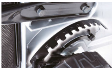
Hoogteverstelling in 5 standen met één hendel.
