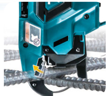
Vlechtdraad (Ø 0,8 mm) Blank staal, gegalvaniseerd of polyester
